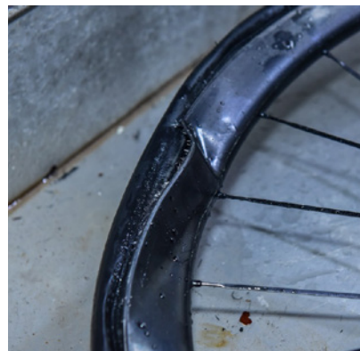
311psiで破壊されたリム
