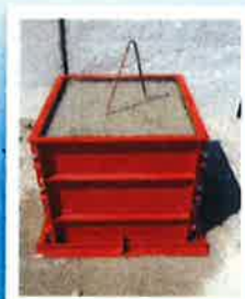
硬化次第 脱枠
